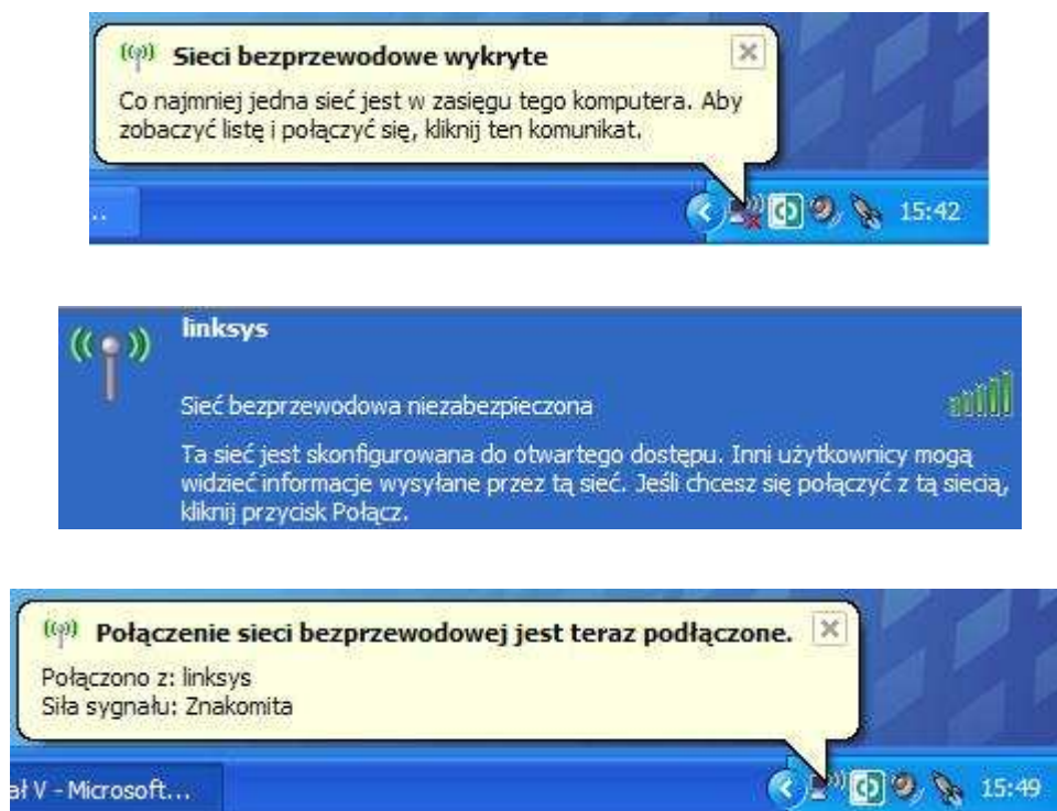
Rys. 10. Kolejne etapy łączenia się z niezabezpieczoną siecią.
